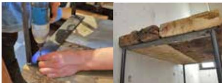
1. 天板を裏返しに置きます。その上に鉄脚を逆さにして載せ、ビスで留めます。この際、両脚の取り付け位置がずれると、板の反りやがたつきの原因になりますので気をつけてください。
