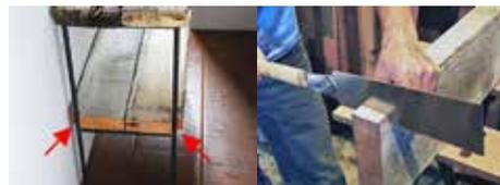
2. 中段に使用する棚板の準備をします。そのままと左の画像のように鉄脚に当たる部分(矢印部)が生じます。脚を避けるように、予め板の角に欠き込み(かきこみ)を入れておくと、奥行き狭い板を使用してください。
